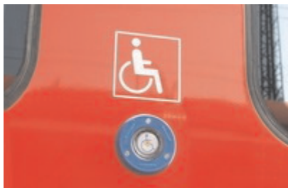
Ruftaste zur Anforderung des Triebfahrzeugfahrers zur Auslegung der Überfahrhilfe (Höhe: 85 cm)
